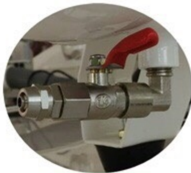
วาล์วปล่อยลมที่ติดตั้ง
